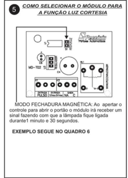
En caso que se necesite accionar una **ELECTROCERRADURA**, el **JUMPER** de selección debe estar **“CERRADO”**, en este caso la salida de la central se acciona durante 3 segundos.
